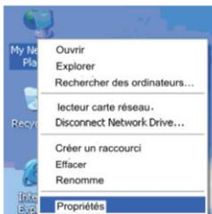
**Étape 2** Faites un clic droit sur l'icône de l'adaptateur réseau et choisissez **Propriétés** dans le menu. La fenêtre **Propriétés de la connexion au réseau local** apparaît.
